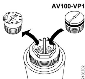
コンビバルブのグランド部からリークが有る場合、ストロークリミッターをバルブインサート AV100-VP1 に交換することができます。
