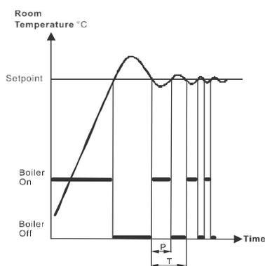
一般に PID 制御は、2-ポジション制御よりも快適でエネルギー効率が高くなります。
