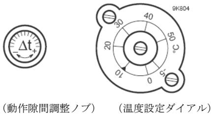
(動作隙間調整ノブ) (温度設定ダイヤル)
