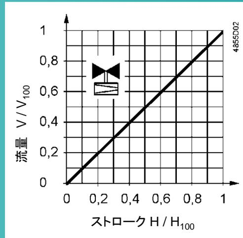
バルブに比例式のアクチュエータ(SSA61)を取り付けた場合、アクチュエータは制御信号(DC 0-10V)でリニアにバルブのストロークを制御します。
