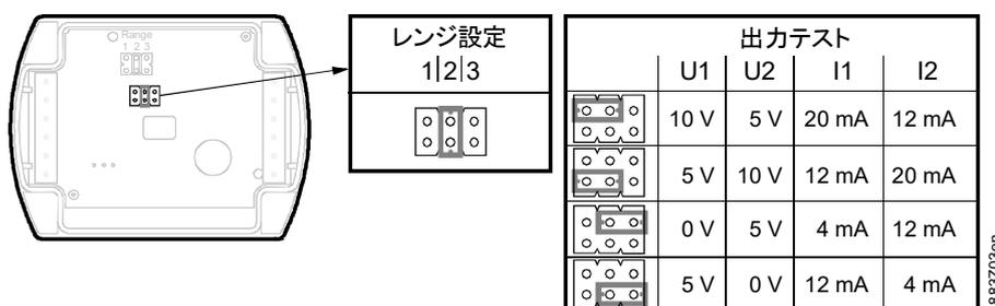
温度設定エレメントは、6本のピンと短絡プラグから構成されており、温度の計測レンジの設定および出力テスト機能を設定可能です。
