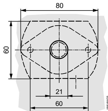
ダクト型では、寸法に合わせて取付孔を加工します。
