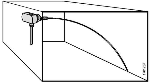
(注) 感温部がダクト面に直接接触しない様にして施工してください。
