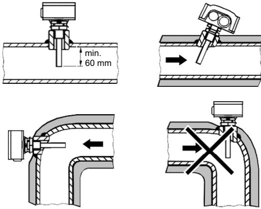
(注) L部に挿入する場合、挿入部が流れに対抗する向きで取付けてください。
